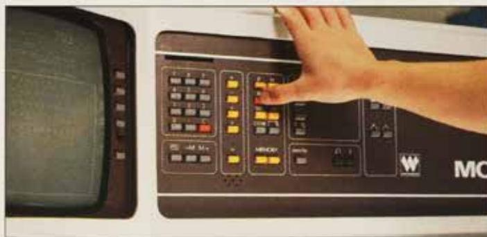
Betjeningspanel og TV-skærm på elektronisk skæremaskine.
